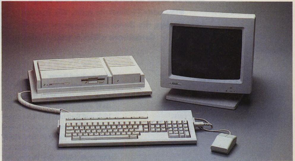
Ein TT-Komplettsystem, bestehend aus Zentraleinheit, Tastatur und Farbmonitor
